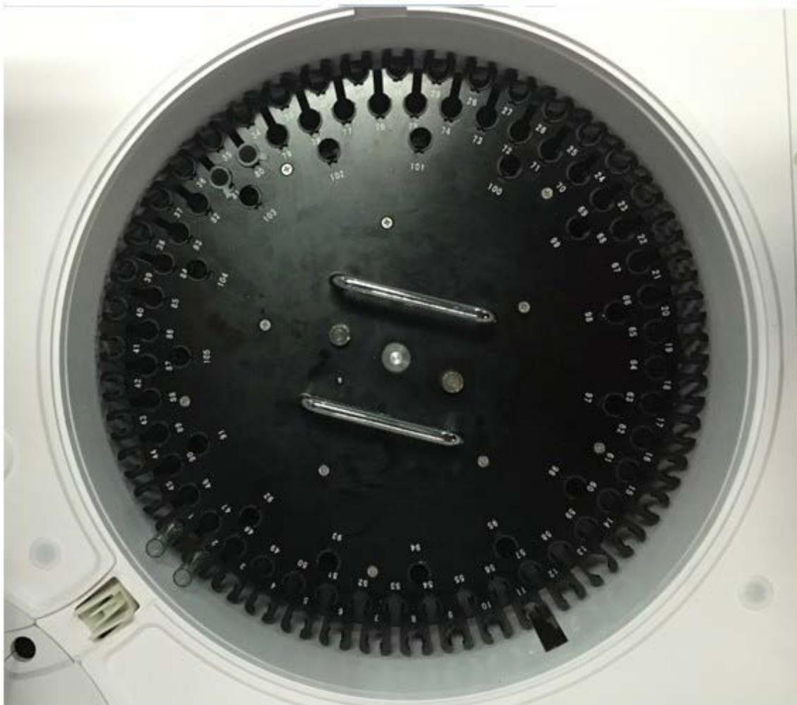
Иллюстрация 3-7: Конструкция диска образцов
