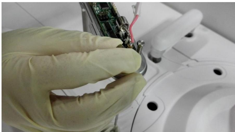
5) Отсоедините соединительный кабель от пластины обнаружения уровня жидкости и потяните иглу вверх, чтобы вынуть ее, как показано на следующем рисунке:
