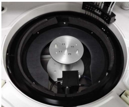
Иллюстрация 3-11: Конструкция инкубатора реакции
